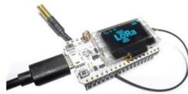
*Fig. 1 Heltec Wifi Lora 32 V2*
