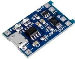
*Fig. 4 Lithium Charger Module*
