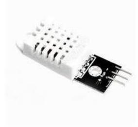
*Fig 3. DHT22 sensors*
