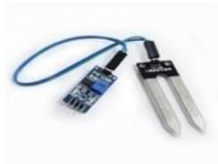
Fig 4. Soilmoisture Sensors
