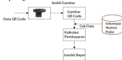
Gambar 2. Blok Diagram Sistem Pembayaran
