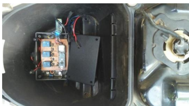
Gambar 7. Pengujian dan Implementasi Sistem Keamanan Kendaraan Bermotor dengan ESP32 menggunakan kontrol Android (Sumber: Data pribadi peneliti, 2024)
